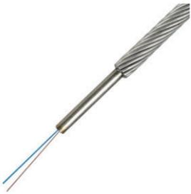
Волоконно-оптические кабели с оптическим волокном в бронированной трубке из нержавеющей стали создаются по запатентованной технологии изготовления трубки, которая обеспечивает герметичное уплотнение. Армирующие стальные проволоки обеспечивают улучшенный порог схлопывания (раздавливания) и предел прочности на разрыв, при этом сохраняя хорошую гибкость. Бронированная трубка из нержавеющей стали может использоваться в различных областях, таких как мониторинг температуры и прокладка грозотросов.
