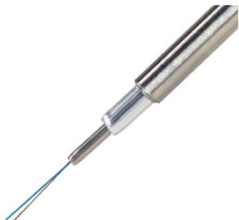
Высокотемпературные скважинные кабели специально разработаны для использования в нефтяных и газовых скважинах при температуре более 150°C. Конструкция включает слой, который значительно препятствует проникновению водорода в структуру кабеля, тем самым продлевая срок службы оптического волокна, помещенного внутри кабеля. Кроме того, высокотемпературный скважинный кабель можно изготавливать из различных сплавов в зависимости от поставленных задач.
